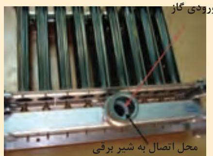
با باز کردن پیچ ها درب محفظه احتراق را باز نمایید. الکترود جرقه زن و حسگر حضور شعله را جدا نمایید. با شل کردن مهره اتصال شیر گاز به مشعل را باز نمایید. پیچ های نگهدارنده مشعل به چند راهه را باز نمایید. پیچ های نگهدارنده مشعل را باز نمایید. مشعل را از جای خودش خارج نمایید.
