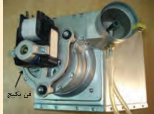
لوله سیلیکونی را از روی فن جدا نمایید. اتصالات الکتریکی را از روی فن جدا کنید. با باز کردن پیچ و برداشتن گیره، آنالیزور دود را خارج نمایید. پیچ های مربوط به اتصال فن به محفظه احتراق را باز نمایید. فن را از جای خودش خارج کنید.
